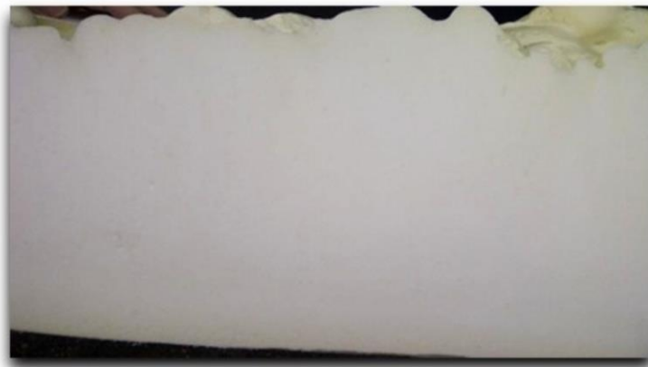
Aspect visuel d'une mousse correctement expansée
