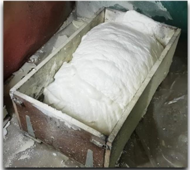
Découper le carré de mousse sur son pourtour pour extraire l'échantillon.
